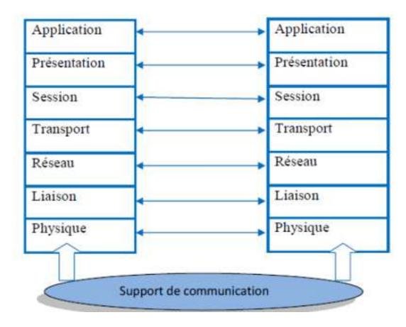
Figure 12 : hiérarchie du modèle OSI
