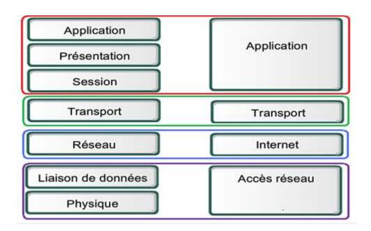
Figure 19 : Architecture réseau à 4 couches
