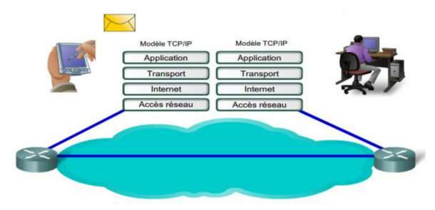
Figure 18: Les 4 couches du protocole TCP/IP
