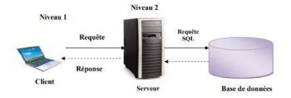
Figure 16 Architecture client/serveur à 2 niveaux
