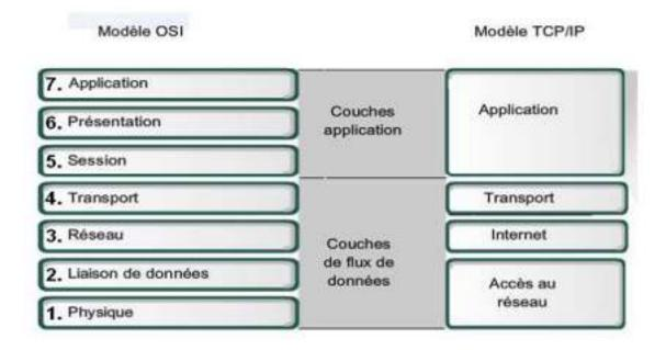
Figure 14 : correspondance entre les modèles TCP/IP et OSI
