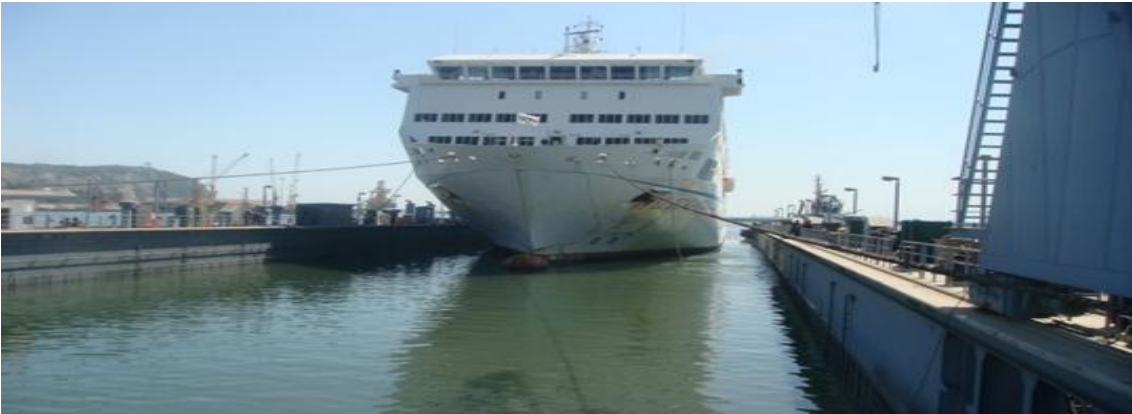
Etape 3 : La pénétration du navire sur le dock.
