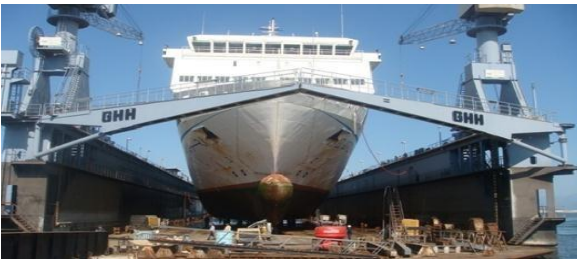
Etape 4 : La mise à sec du navire sur les tins.
