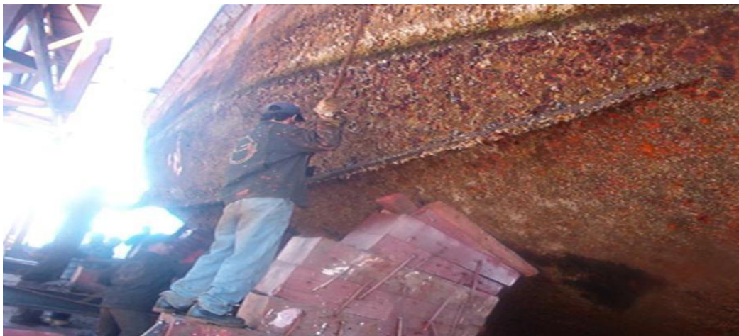
Figure III.10. Grattage de la carène.
