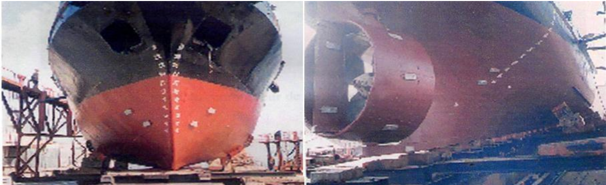
Figure III.15. Marquage des tirants d'eau avant et arrière.
