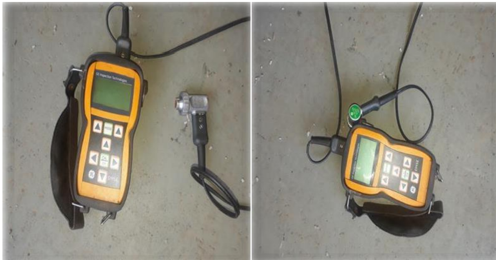
Figure III.13. Appareil de relevé d'épaisseurs.
