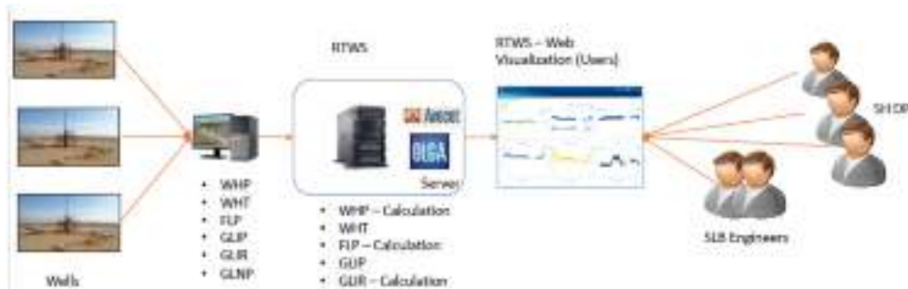
Figure 3. Système de contrôle utilisé par Sonatrach et Schlumberger. Suivi des opérations en temps réel.
