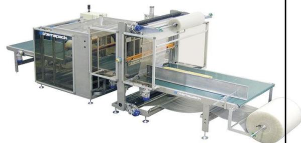
*Figure 11: Fonctionnement d'une machine de fardelage automatique*
