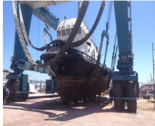
Fig. I.2. 15 et Fig. I.2. 16 : Remorqueur RHUMMEL 4 de l'EPAN mis à sec avec l'élévateur de 400 tonnes de l'ECRN-UCN
