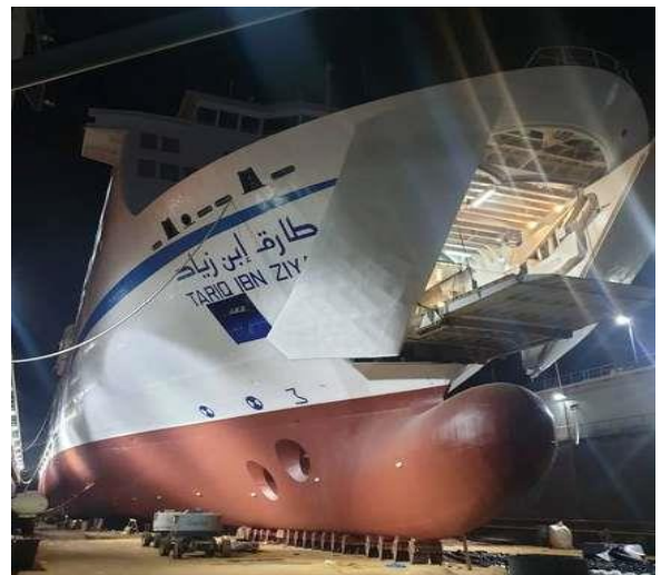
Fig. II.1.30 : Le carferry TARIQ IBN ZIAD à sec sur le dock flottant
