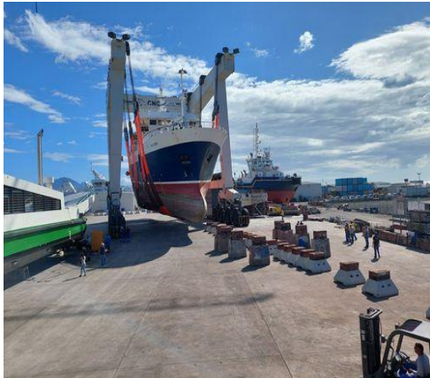
Fig. I.2.17 et Fig. I.2.18 : TRAVEL LIFT MBH 1500, Contrôlé à distance par CIMOLAI TECHNOLOGY SPA. Italie
