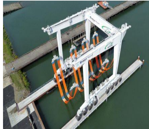
Fig. I.2.17 et Fig. I.2.18 : TRAVEL LIFT MBH 1500, Contrôlé à distance par CIMOLAI TECHNOLOGY SPA. Italie
