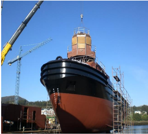
Fig. I.2.9 et Fig. I.2.10 : Nouvelle construction et Assemblage sur chariot et mise à flot par une cale de halage, Remorqueur ZABANA AHMED de l'EPO au Chantier naval ARMON, NAVIA, Espagne
