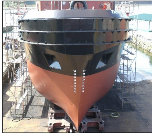
Fig. I.2.9 et Fig. I.2.10 : Nouvelle construction et Assemblage sur chariot et mise à flot par une cale de halage, Remorqueur ZABANA AHMED de l'EPO au Chantier naval ARMON, NAVIA, Espagne
