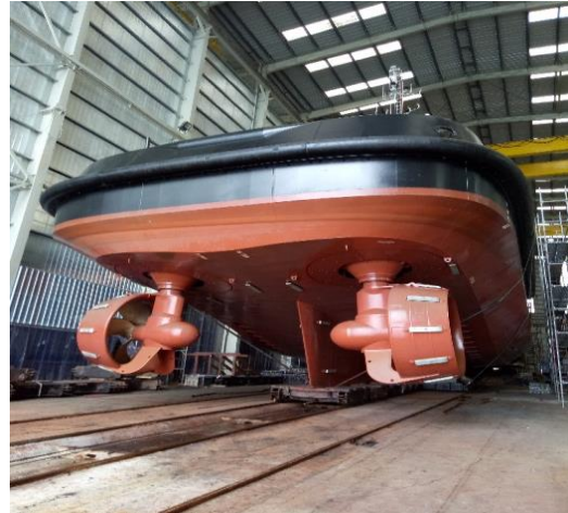
Fig. I.2.11 et Fig. I.2.12 : Chariot sur rail tracté par un câble d'acier et tiré par un treuil, Remorqueur RIZI AMOR de l'EPAN au Chantier naval ARMON, Burella, Espagne
