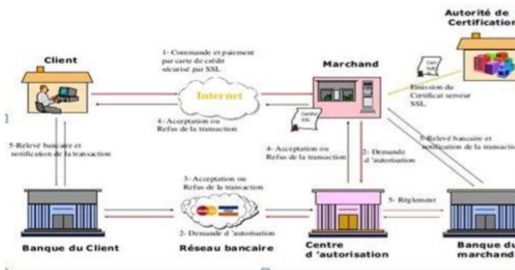
Figure N°12 : les différentes étapes d'un paiement en ligne via une carte
