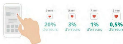
Figure 24: Taux d'erreur en fonction de la taille de la surface active
